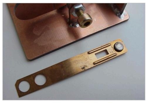
Les contacts relais que j'ai utilisés étaient cloués sur une bande de cuivre (voir photo). Avec un coupe-fil, coupez le point de contact en un cercle d'environ 5,5 mm (7/32"), retirez le bord du fil avec une lime, percez un petit trou dans les supports du point de contact à 5 mm (3/8") du bas pour laisser la partie clouée du contact s'enfoncer dans la carte PC et soudez le point de contact au support.
