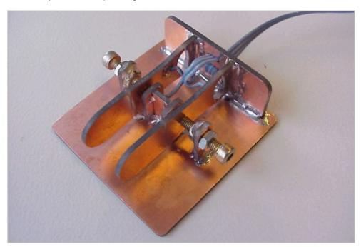
La première idée était d'avoir une vis verticale entre les deux palettes et de laisser l'espacement pour chacune d'elles (loin de la vis centrale ou du contact) juste un peu plus grand que nécessaire lors de la soudure des deux palettes en place. Ensuite, après avoir agrandi ou ajusté les trous des palettes pour la tension nécessaire, les deux vis de réglage pourraient être utilisées comme pour la palette simple, mais elles pousseraient chaque palette plus près de la vis centrale verticale.
