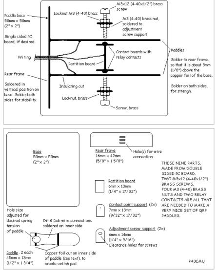
Le cadre arrière, les palettes, les deux supports de vis de réglage, la cloison et les plaques de contact sont tous fabriqués à partir d'un matériau de carte PC double face. Étant donné que deux pièces de carte PC ne permettent pas un contact fiable, j'ai utilisé deux points de contact d'un ancien relais, mais jamais utilisé. La description suivante compte sur l'élargissement
